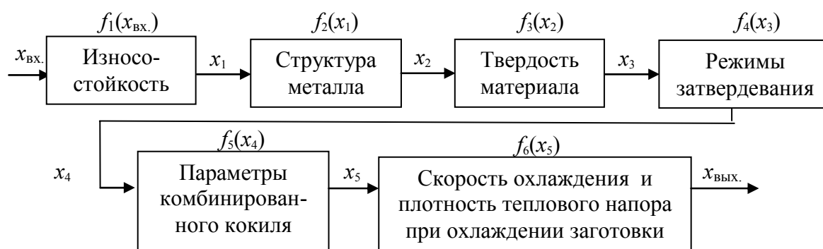
Рис. 2. Алгоритм технологического процесса изготовления гильз цилиндров с повышенными износостойкими свойствами
