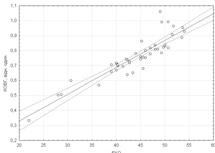
Рис. 3. Залежність показника КОВГ від ємності катіонного обміну
