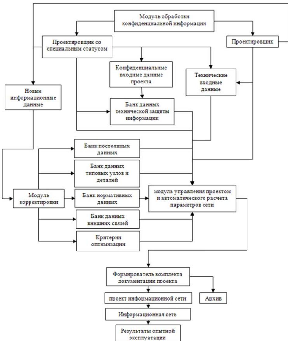
Рис. 2. Блок-схема системи автоматичного проектирования информационной сети
