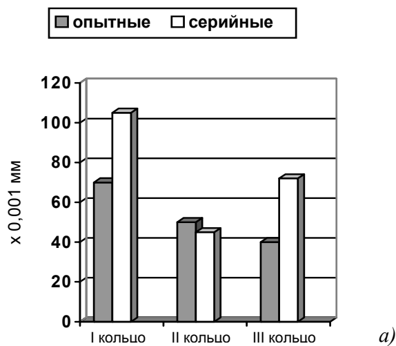
Рис. 7.9. Диаграммы износа поршневых колец дизеля СМД-14 по изменению радиальной толщины за:
