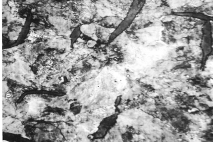
Рис. 4.1. Структура вермикулярного чугуна поршней дизеля ЧН 25/34, \times 100
