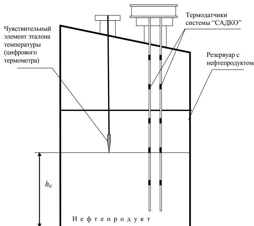
**Рис. 3. Структурная схема экспериментальных исследований ИК температуры**
