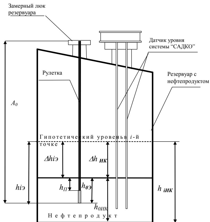
**Рис. 2. Структурная схема выполнения операций поверки ИК уровня системы “САДКО”**
